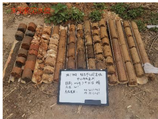
W1 地下水监测井钻探岩芯
