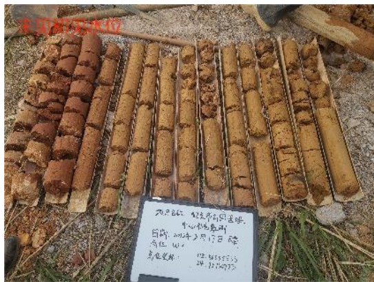
W2 地下水监测井钻探岩芯
